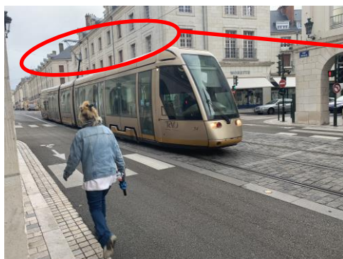
〔架線レス区間はパンタグラフを収納する〕
