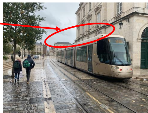
〔架線レス区間はパンタグラフを収納する〕
