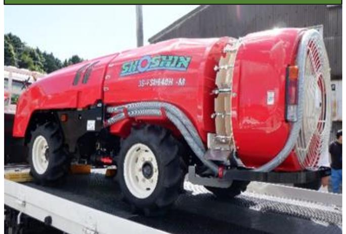
※果樹の病害虫防除のための農薬等を均一に散布する作業機械。防除作業を効率化
