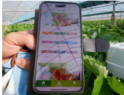
ビニールハウス内環境モニタリング 温度や湿度等の環境をモニタリングして見える化
