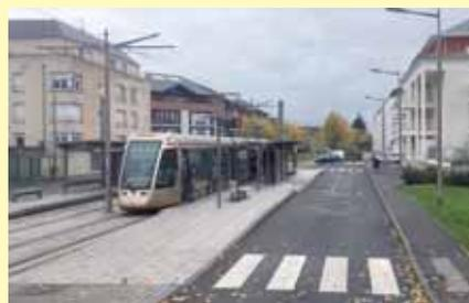
オルレアン市では、路面電車の停留所のまわりをバスが周回するようになっており、電停がそのままバス停として使用されています。また、景観を守るために架線をなくして給電用レールを使用している所があります。
